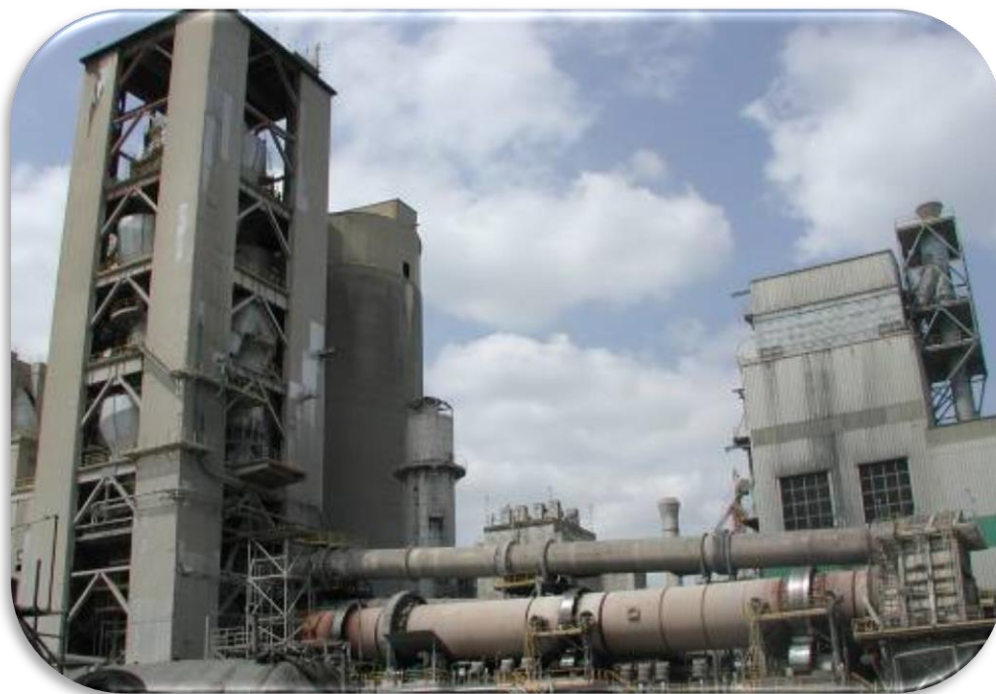
Slika 2.4 Rotaciona peć sa četvorostepenim ciklonskim predgrejačem
