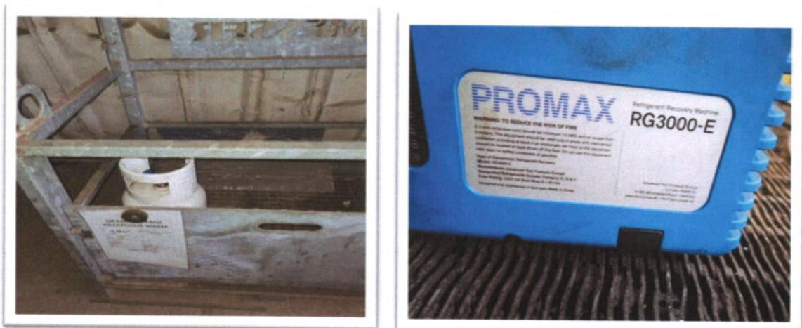
Слика 11 и 12 – рекуператор за боцом
