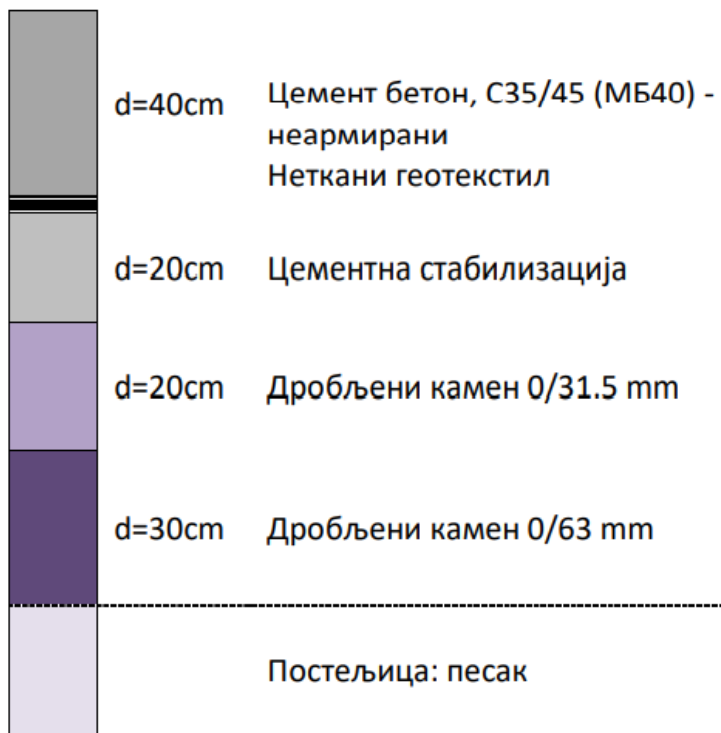
Слика 31 Пројектно решење круте коловозне конструкције на платоу за складиштење контејнера и на маневарском платоу (Извор: ИДП, Свеска 2.2. Пројекат саобраћајница, саобраћајних површина и отворених складишта)
