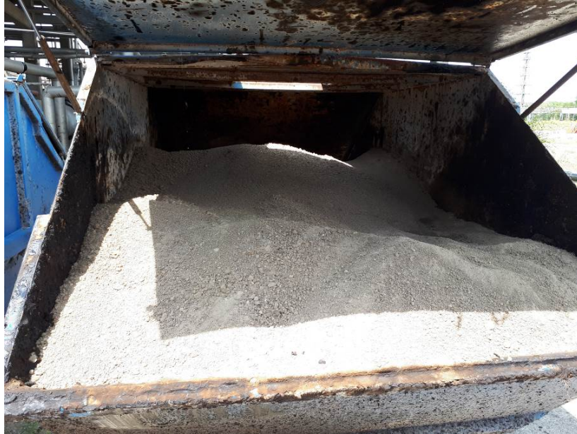
Slika 17. Kontejner sa solidifikatom kao izlaznom frakcijom
