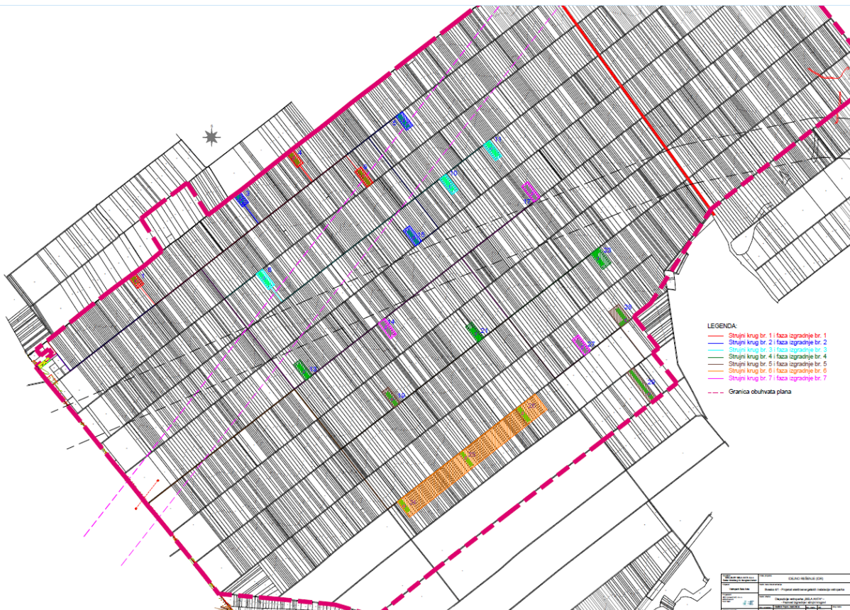
Слика бр. : 1 Диспозиција ветропарка „Бела Анта“ – Фазност изградње и струјни кругови (Графички приказ у прилогу Захтева)
