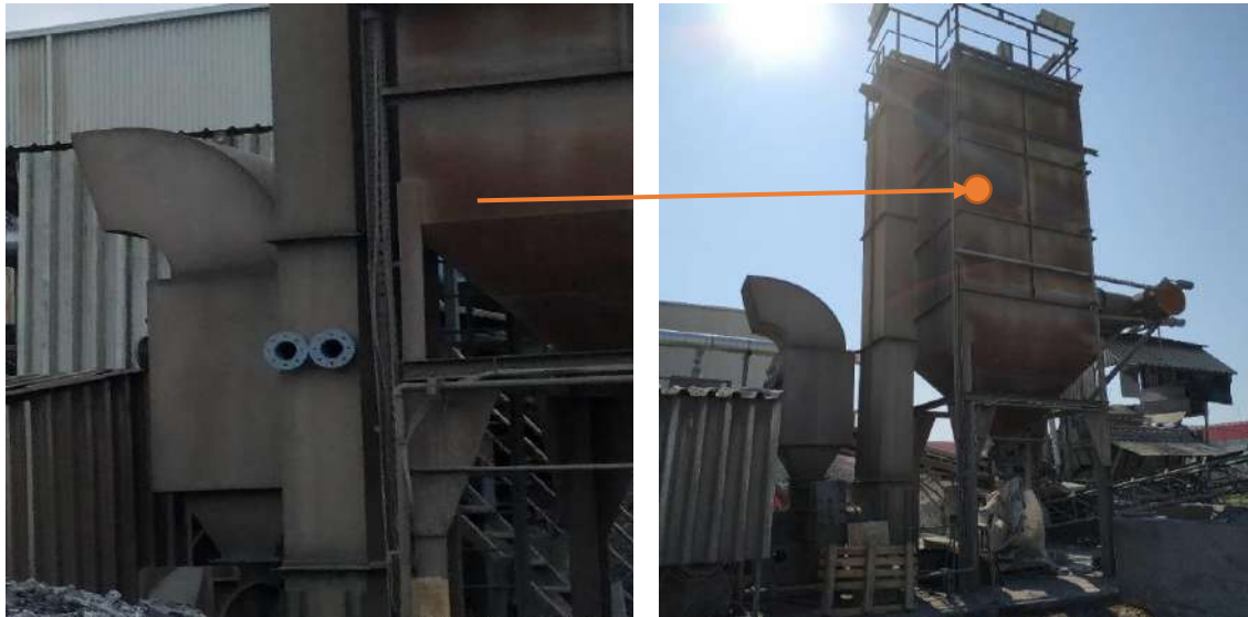
Слика 6.3.7 – Врећасто филтер за пречишћавање гасних струја из сепаратора шљаке и емитер Е2
