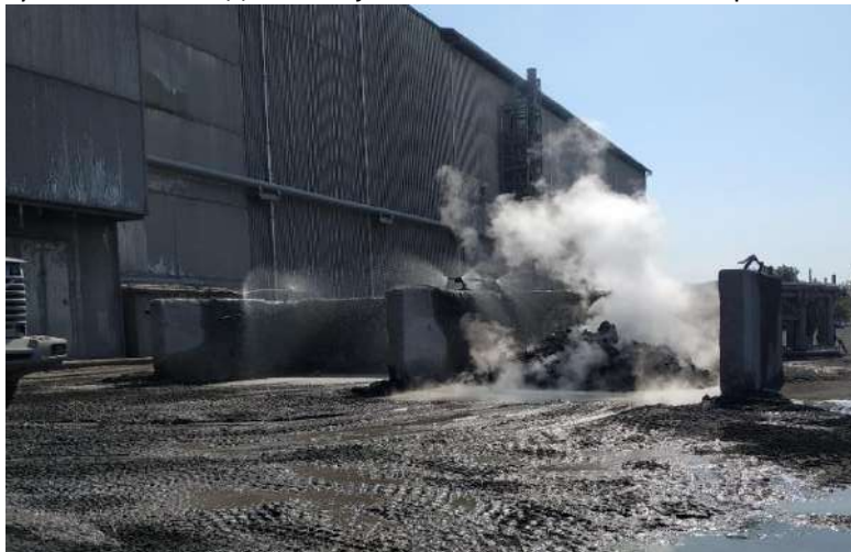
Слика 8 – Хлађење шљаке у боксовима за хлађење
