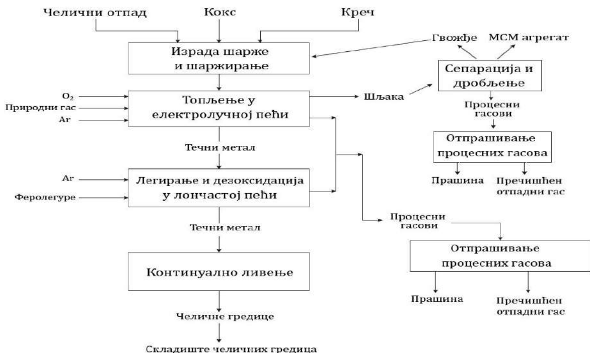
Слика 1. – Блок шема технолошког процеса топљења и ливења челичних гредица
